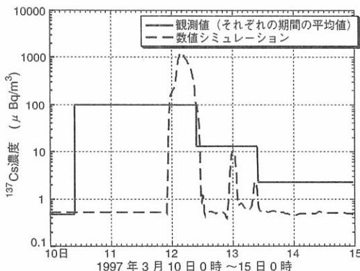
図4 つくばでの<sup>137</sup>Cs濃度の時間変化。図1に示した<sup>137</sup>Cs濃度の時間変化を事故時を中心拡大表示したものと、本数値シミュレーションによって得られた<sup>137</sup>Cs濃度の時間変化。観測された時間変化はそれぞれの期間の平均値であり、とくに3月10日10時から12日10時までは、爆発事故以前の三十数時間を含んでいることに注意されたい。
