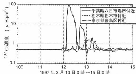
図5 関東各地での<sup>137</sup>Cs濃度の時間変化。数値シミュレーションによって得られた値をつくばからそれぞれ約60km(つくばから東海村までの距離)離れた3地点について示す。つくばから南西の八日市場市での濃度の変化は、つくばでの変化と基本的には同様であり、12日明け方から濃度が上昇し、最大約  $100 \mu\text{Bq}/\text{m}^3$  となっている。その後、事故以前の濃度まで下がったが、12日午後から12日深夜にかけて再び上昇している。つくばから北西の栃木県栃木市では12日昼ごろと12日深夜に  $10\sim20 \mu\text{Bq}/\text{m}^3$  程度の濃度となっている。つくばから南西の東京都豊島区では、約  $1 \mu\text{Bq}/\text{m}^3$  程度の濃度上昇が12日に3回みられる。
