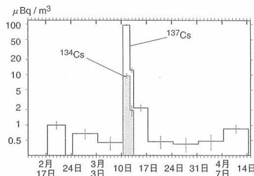
図1 つくばにおける地表大気中放射性セシウムの濃度変化。グラスファイバー濾紙を使い大気中の大気浮遊塵を捕集し計測して得られた放射性セシウムの濃度。毎分  $700 \text{ l}$ (1日ではおよそ  $1000 \text{ m}^3$ )の大気を連続吸引しており、通常は毎週月曜日10時ころに濾紙交換をおこなうので1週間分の大気浮遊塵を集めることになる。緊急時には、本文に示すように臨時に濾紙を交換する。この濾紙上の放射能総量を測定器によって計測し、通過した空気の量で割って  $1 \text{ m}^3$ あたりの放射性セシウムの濃度を求めている。したがって示されている濃度は、それぞれの試料採取期間における平均値である(文献<sup>(3)</sup>図3)。
